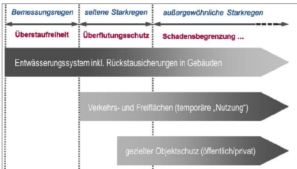
Abbildung 2: Überflutungsschutz und Starkregenrisikovorsorge, DWA M119 [8]
