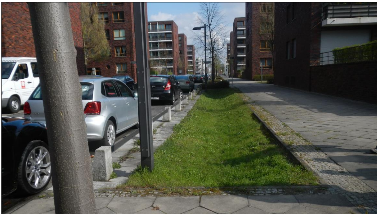
Abbildung 5: Straßenbegleitende Versickerungsmulde in Rummelsburg (Foto: IPS)
